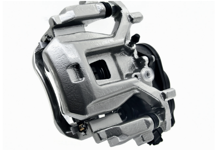
Bei einer elektrischen Parkbremse wird durch den Schalter im Innenraum der Aktuator aktiviert, der mechanisch die Bremsbeläge gegen die Bremsscheiben presst. In der Steuereinheit ist ein festes Stromprofil für den Anpressdruck der Bremse hinterlegt; das der Shunt beim Betätigen der Bremse überwacht. Bild: ©Shutterstock
