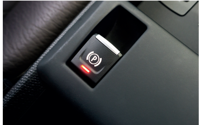
Ein Druck aufs Knöpfchen genügt, um die elektrische Parkbremse zu aktivieren und das Fahrzeug sicher auch an abschüssiger Stelle zu parken.
